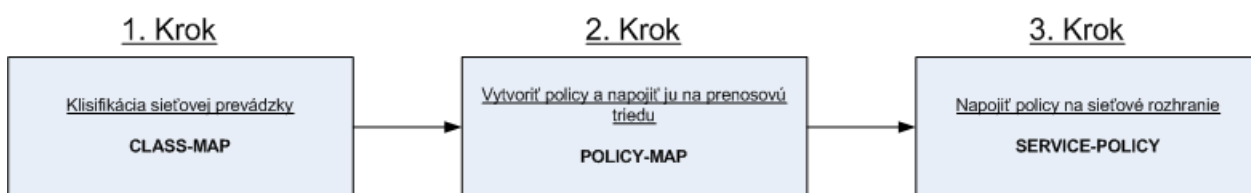
Obr. 5.1 – 1 Postup pri konfigurácii QoS na Cisco zariadeniach
